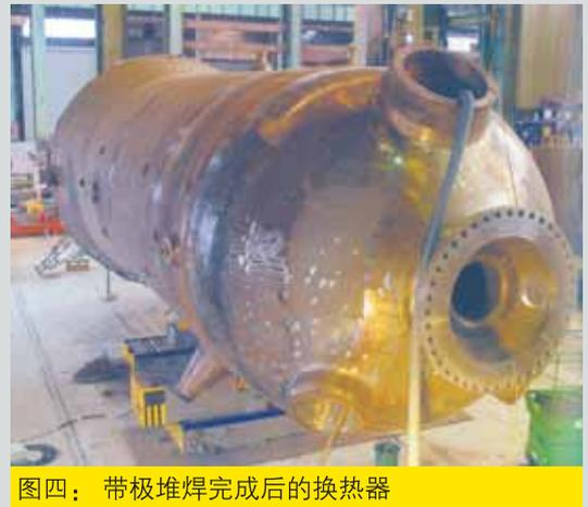
图四：带极堆焊完成后的换热器
