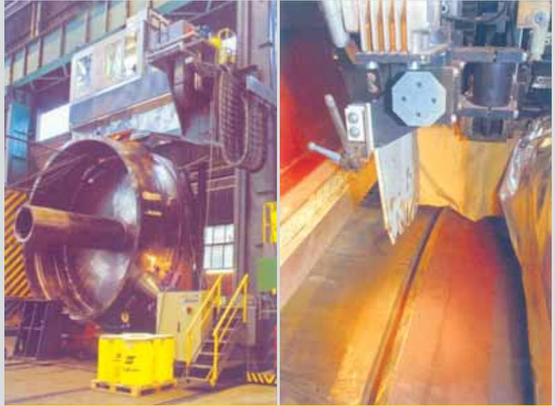
图二：环形焊缝窄间隙焊，280kg桶装焊丝避免了频繁换焊丝的时间
