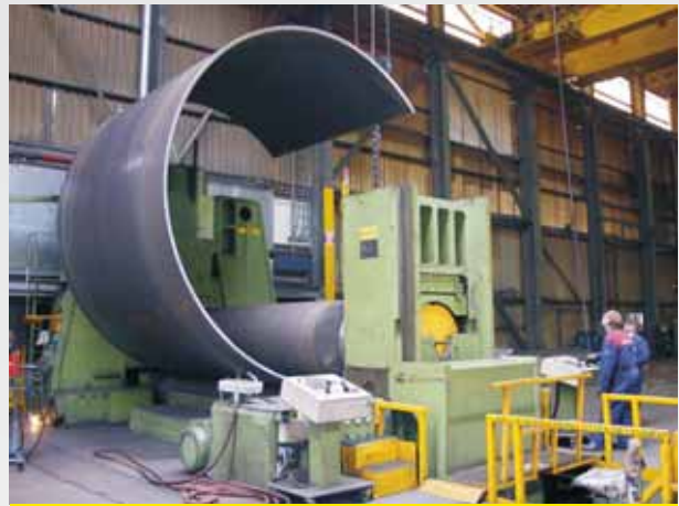
图4 制造单基桩制钢管第一步，卷板
