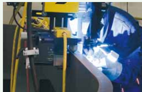
环焊缝的焊接
