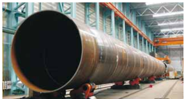
图3 单基桩制钢管环缝和纵缝的制造
