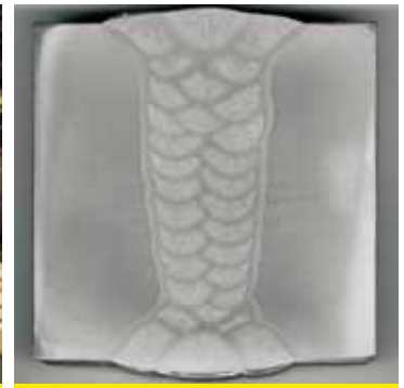
图7 板厚70mm典型焊缝横截面宏观外形
