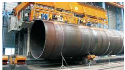
图8 焊接环缝门架上的焊接操作工
